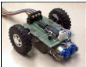
ツインモータギアボックスとドライバ IC・TA7279P/AP を用いた DC モータ制御の学習キットです。フォトフレクタによりタイヤの回転数を検出することが出来ます。学習内容はユニバーサル基板にハードを実装するところから始め、単純な PIO での制御、PWM での制御、応用として回転数一定制御をプログラムしていきます。
