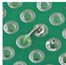
3. ハンダ付けする部品の足にラッピングケーブルを絡めてからハンダ付けします
