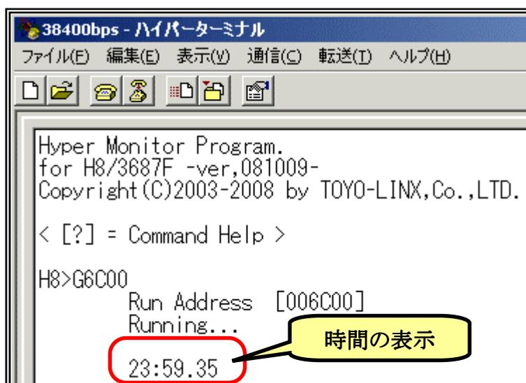
TK-3687mini のリセットスイッチ (SW1)を押すと、実行中のプログラムは停止して、ハイパーH8 は下図のように入力待ちの状態になります。
